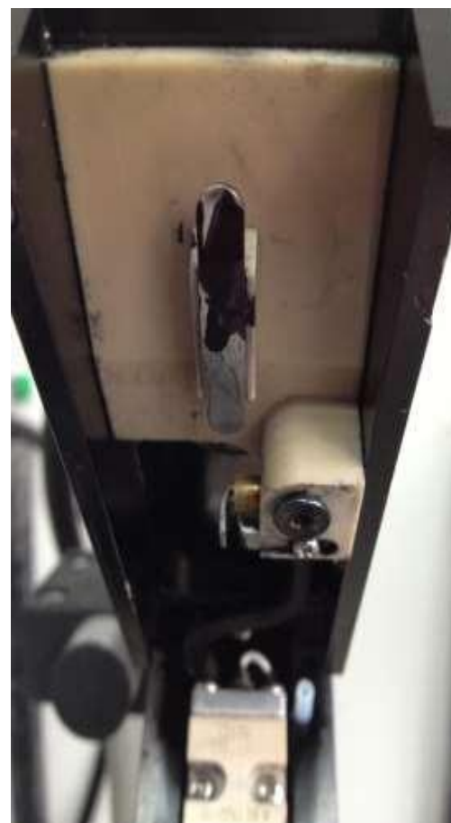
Fig. Placa de deflexão suja, defeito causado pela Alta Tensão.
