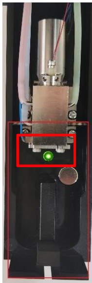
Fig. Aplique solvente na Área Demarcada e seque adequadamente. (Eletrodos E Canhão)
