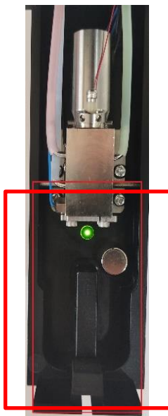
Fig. Aplicar Solvente na Área Demarcada e Secar Adequadamente. (Eletrodos e Canhão)
